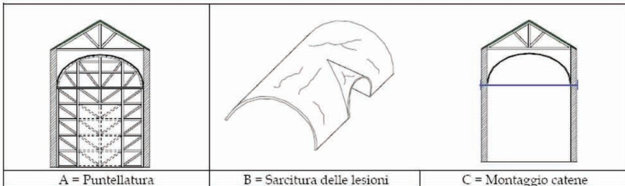
Figura 16. Schemi tipologici di interventi nelle volte e negli archi
